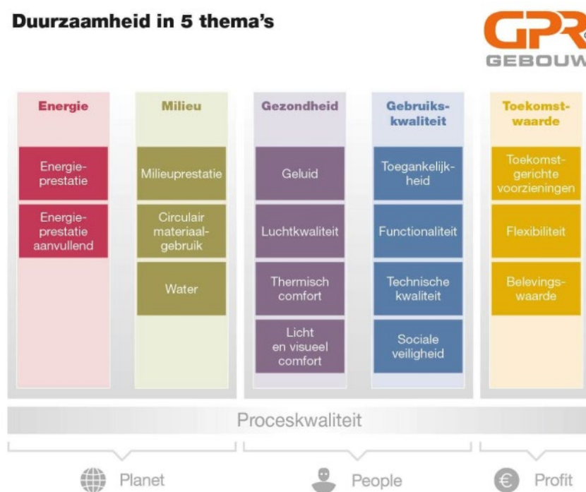
Figuur 1: De GPR Gebouw berekening is opgebouwd uit vijf thema's die staan voor Planet, People, Profit.
