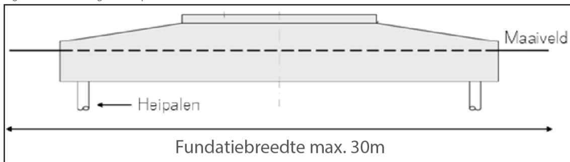
Figuur 2.3 Fundering met heipalen
