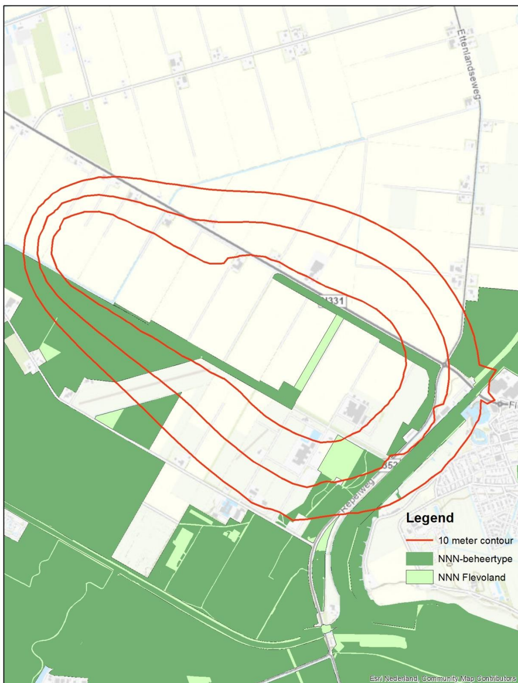
Figuur 12. De 51, 45 en 42 dB(A)-contouren berekend voor 10 meter hoogte (rode lijnen), waarbij de binnenste lijn de 51 dB(A)-contour weergeeft en de buitenste de 42 dB(A)-contour. In lichtgroen het NNN dat nog niet is ingericht en in donkergroen het NNN met een beheertype. (bron contouren: Dgmr; bron kaartondergrond: Esri Nederland Community Map Contributors).
