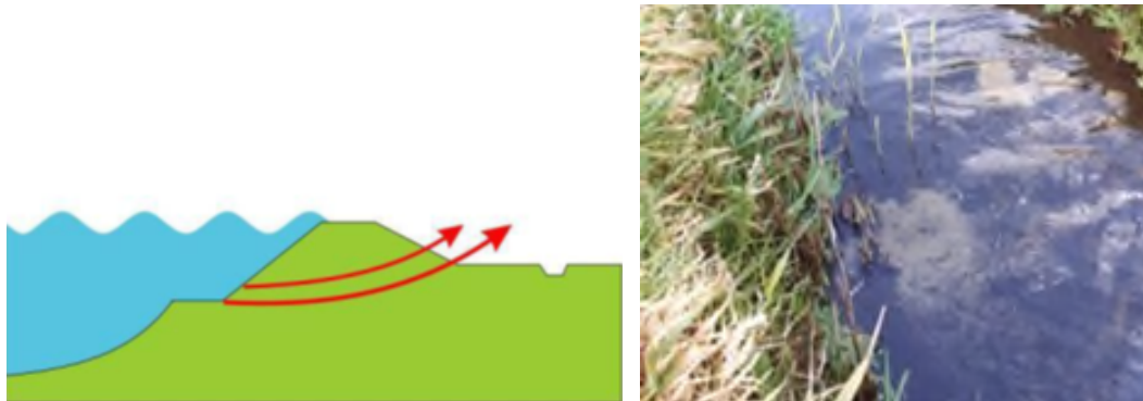
Figuur 2.3 Schematische weergave van piping als faalmechanisme (helpdeskwater.nl) en een foto van de huidige zandvoerende wellen in de teensloot in het projectgebied
