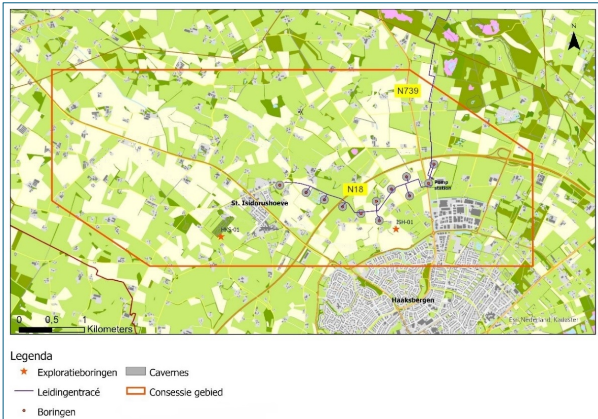
Figuur 5-1: Caverneveld met 12 zoutwinningslocaties
