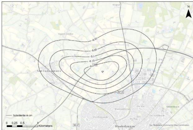
Figuur 3-1: Verwachte bodemdaling 50 jaar na start productie (in m.) voor 12 cavernes met een veilige omvang van gemiddeld 2,1 miljoen m 3 .
