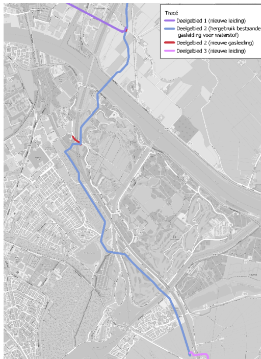
Figuur 3-5 Ligging bestaande voor waterstof in te zetten gastransportleiding in deelgebied II
