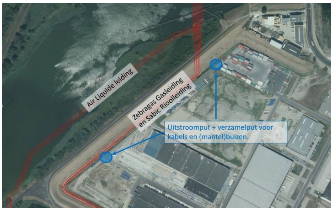
Afbeelding 1.1 Bestaande kabels, leidingen, uitstroomput en verzamelputten
