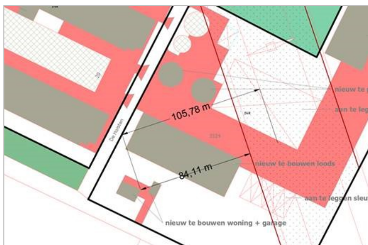
Figuur 43: Afstand bedrijfswoning tot indicatieve magneetveldzone hoogspanningslijn
