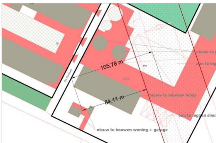
Figuur 43: Afstand bedrijfswoning tot indicatieve magneetveldzone hoogspanningslijn
