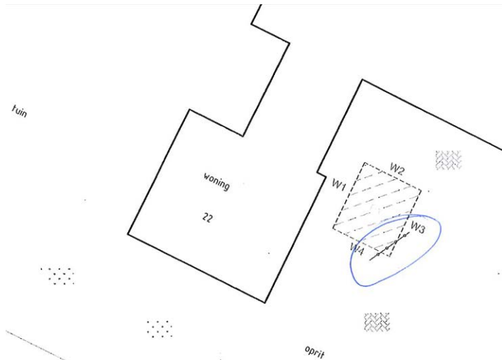
Figuur 8: Ontgravingsput HBO-tank met lokatie asbestvondst.
