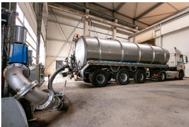
Figuur 1-2 Inpandige ontvangst van ingaande grondstoffen bij Bio Energy Coevorden BV (bestaande situatie)
