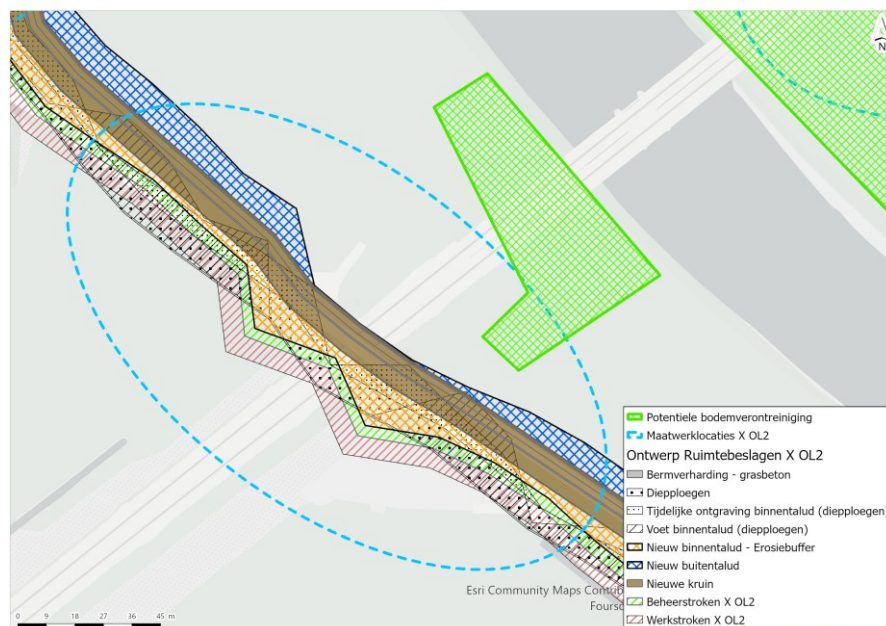
Afbeelding 6-6 Potentieel verontreinigde bodem (groen geruite vlak) bij deeltraject 5X. Met de blauwe contour is de maatwerklocatie aangegeven.
