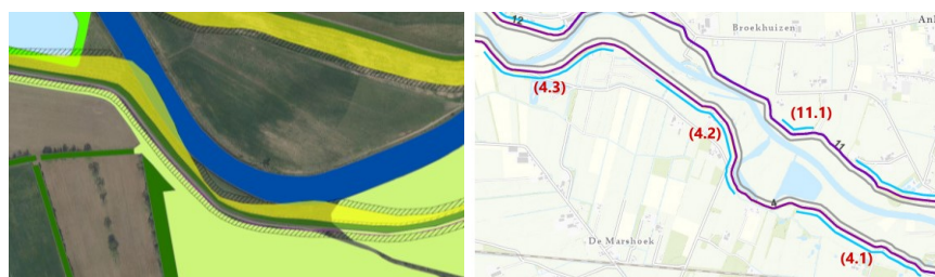
Afbeelding 6.21 Deeltraject 4- alternatief Z. links ingezoomd op ruimtebeslag rivier en kolk door voorlandverbetering (geel); rechts locaties van de verticale voorzieningen (licht blauwe lijnen).
