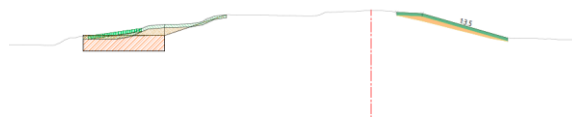
Afbeelding 6.8 Deeltraject 2: dwarsprofielen, alternatief X diepploegen met erosiebuffer (links), alternatief Z verticale voorziening en gras op klei (rechts)
