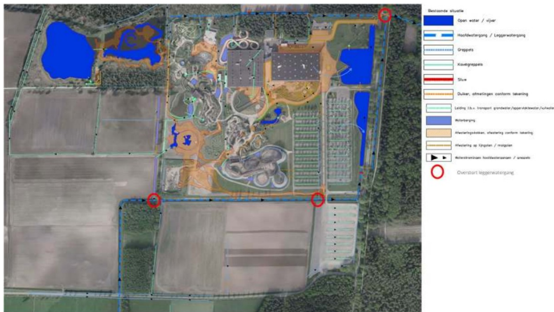
Afbeelding 16 Globale situering hemelwatersysteem (vergroot weergegeven in bijlage B1)
