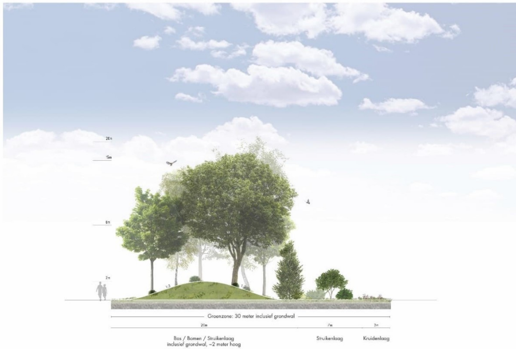
Afbeelding 26 Principedoorsnede noordelijke randzone inclusief te beplanten grondwal
