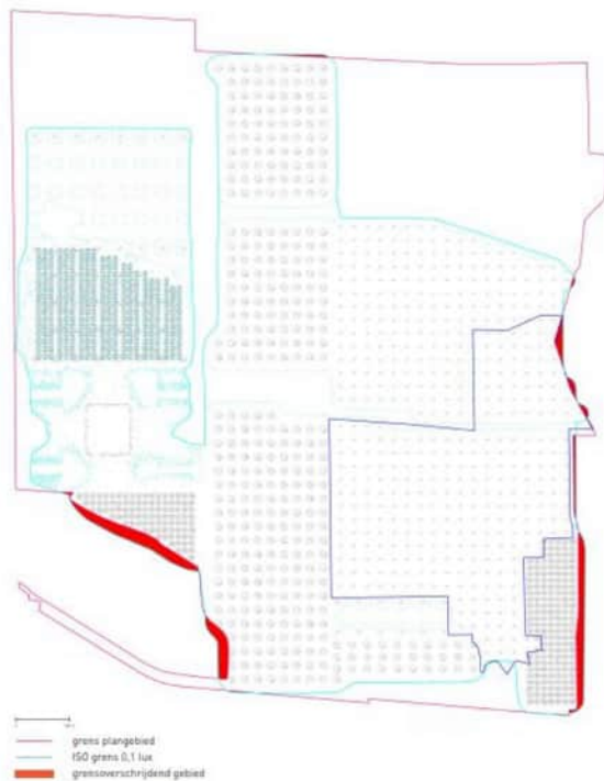
Afbeelding 38. Weergave van de toename aan verlichting boven de drempelwaarde 0,1 lux buiten de begrenzing van het plangebied voor ontwikkelmodel 1B.
