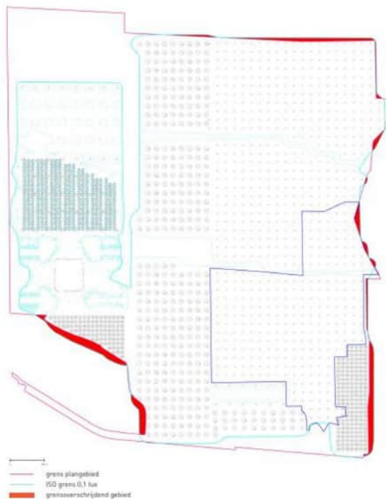
Afbeelding 35. Weergave van de toename aan verlichting boven de drempelwaarde 0,1 lux buiten de begrenzing van het plangebied voor ontwikkelmodel 1A.
