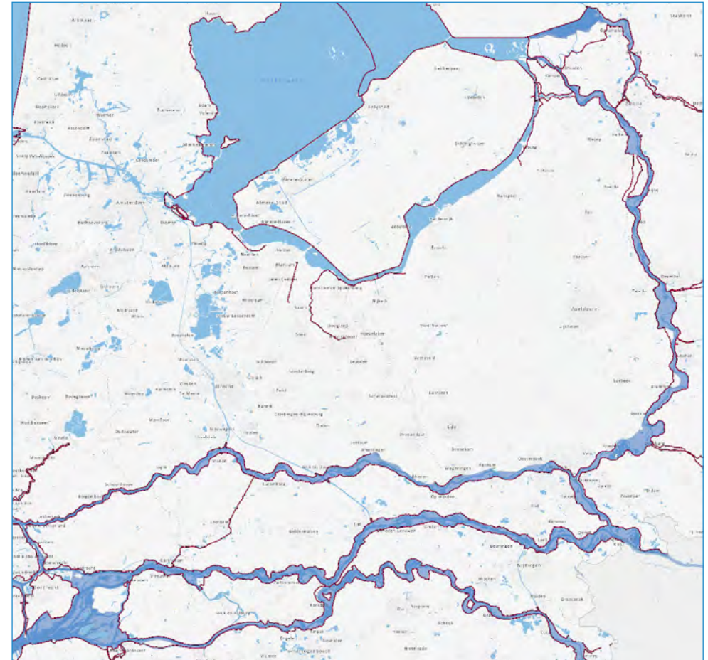
Figuur 35 De winterbedbreedte van de Rijntakken (en Maas) kan worden afgeleid uit een topografische kaart met aanduiding van het winterbed. (NB: Er zijn grote breedteverschillen per traject (zie de tekst).
