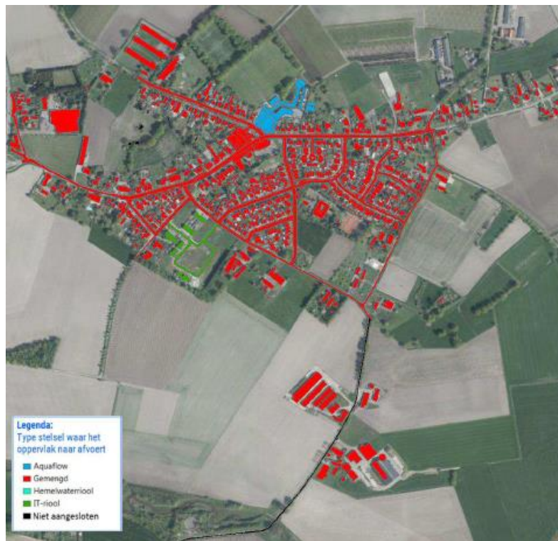
Figuur 7.7: Type stelsel afvoer oppervlak Tungelroy
