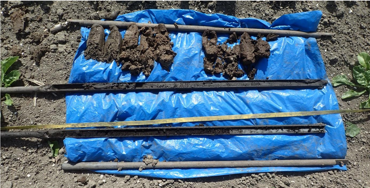
Opname van boring 2
