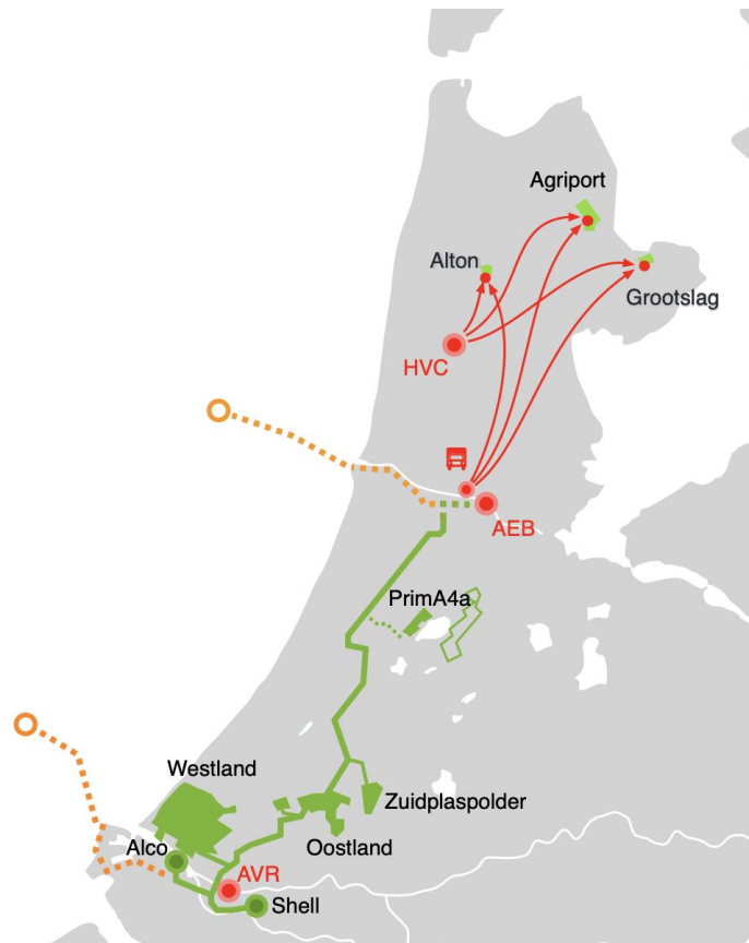
Figuur 1 - Huidige OCAP-pijpleiding (groen). AVR en AEB kunnen hierop aangesloten worden. HVC en liquefactie-installatie noordkant OCAP kunnen mogelijk glastuinbouw in noord Noord-Holland voorzien (rood). Daarnaast is er een plan voor CCS (oranje)
