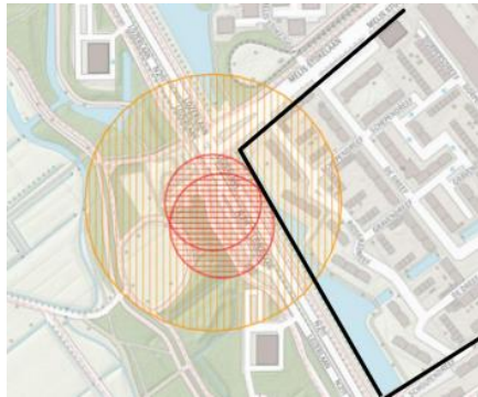
Figuur 7.23 Het brand- (rood) en explosieaandachtsgebied (oranje) met betrekking tot het LPG-tankstation Lozerlaan 1555. Met zwart is de plangrens van Dreven aangegeven.
