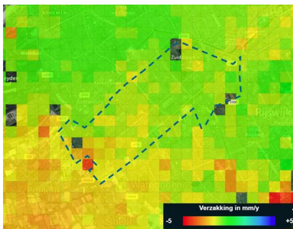
Figuur 5.101 Bodemdaling in de periode 2014-2020 (bron: Bodemdalingskaart.nl)
