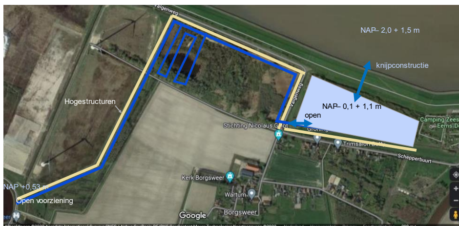
Figuur 26 Principe schets van gedempt getij meertje met zoet-zout vismigratieriviertje
