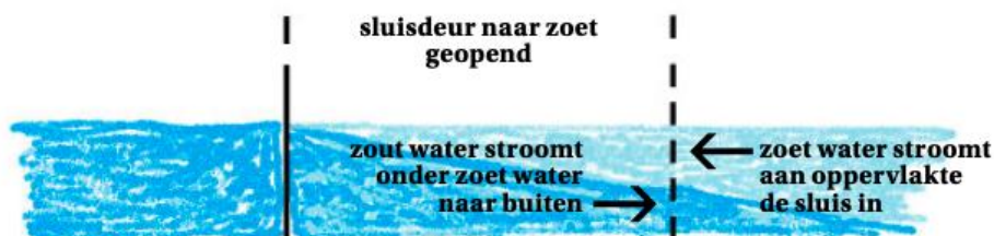
Figuur 4 Zoutindringing bij een sluis
