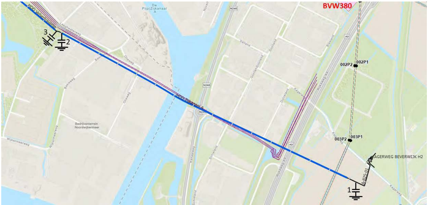
Figuur 3: Modellocaties langs de buis capacitieve aardingen (ac-drainages) nrs. 1, 2, 3, zie Tabel 7
