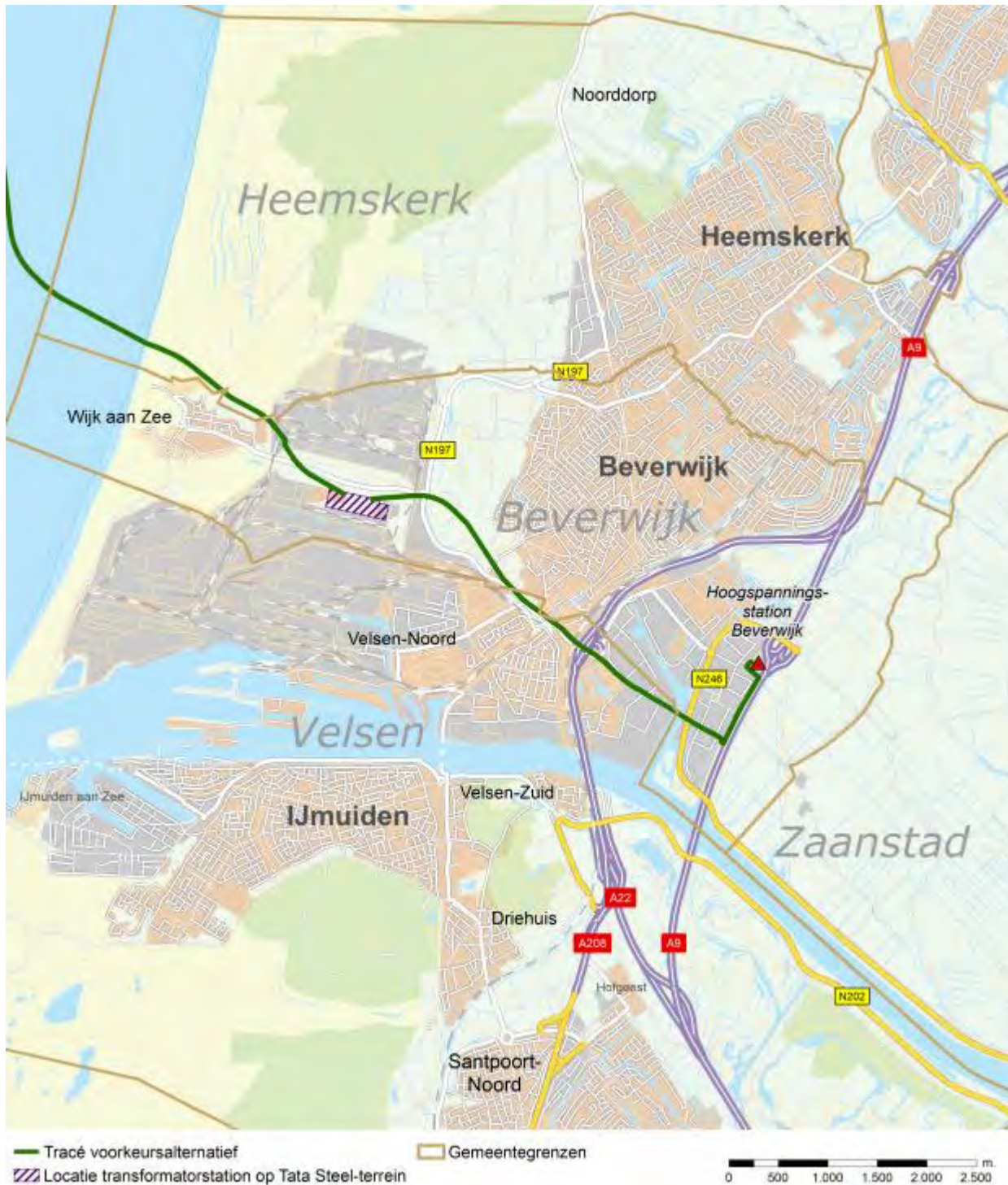
Figuur 24: Landtracé kabelverbinding Hollandse Kust Noord. Bron: https://www.netopzee.eu/hollandsekustnoord/waar-ligt-de-netaansluiting-hollandse-kust-noord-en-west-alpha (01-11-2023). Gearceerd is het 380kV-hoogspanningsstation HKN Landstation. Het landtracé wordt volledig geboord.
