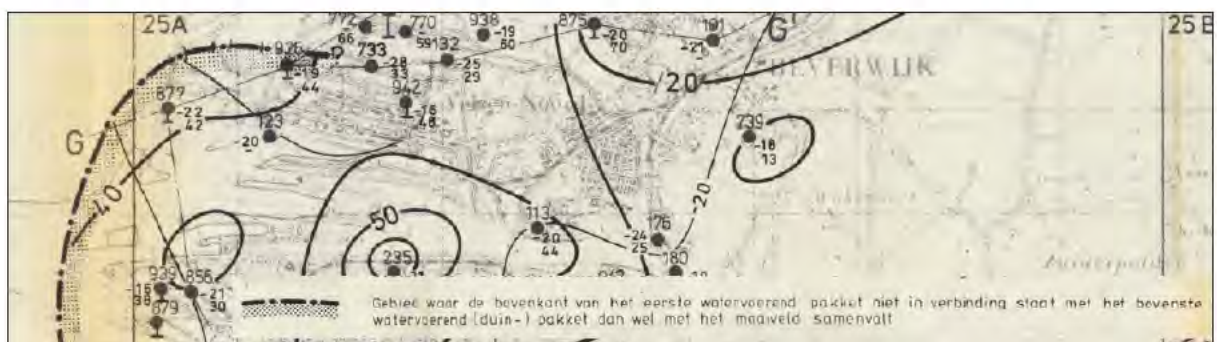
Figuur 3-6: Uitsnede bijlage 9 Grondwaterkaart van Nederland 24, 25 oost en 25 west, verbinding duinpakket en 1° watervoerend pakket
