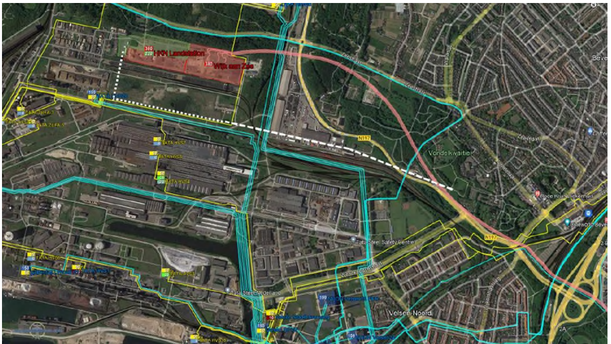
Figuur 15-3 Een deel van de kabels en leidingen in de ondergrond in deelgebied I (bron: Arcadis, 2023)
