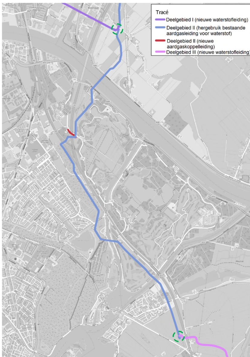
Figuur 19-2 Tracé omgebouwde aardgasleiding deelgebied II met nieuwe aardgaskoppelleiding (rode lijn) en de afsluiterlocaties (locaties zijn groen omcirkeld)
