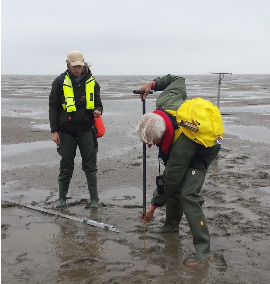
Figuur 2.1 Plaatsing van een grondanker in de bodem van Ballastplaat. 20-6-2018. Foto: Marijke Olivierse.
