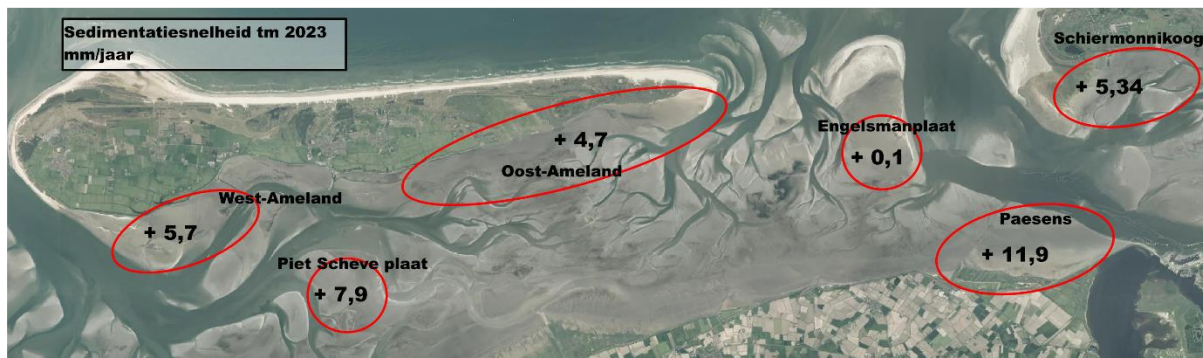
Figuur 17. Sedimentatiesnelheid per onderzoeksgebied in mm/jaar. De reeksen waarop het gemiddelde is gebaseerd variëren in lengte van 9 tot 22 jaar. De data is bijgewerkt t/m 2023.
