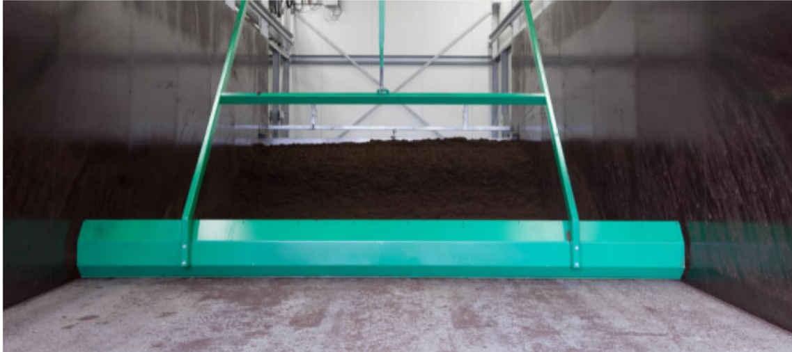
Afbeelding 5 voorbeeld van een toploader in een sleufsilo
