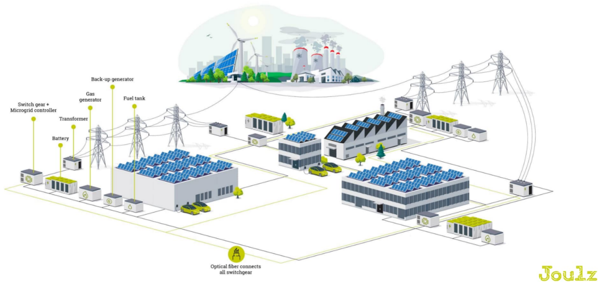
Figuur 17-6 Impressie smart-grid (illustratie: Joulz). Door in te zetten op duurzame opwek en het slim delen van energie in combinatie met opvang van energie in batterijen kunnen de problemen van de netcongestie worden ondervangen.
