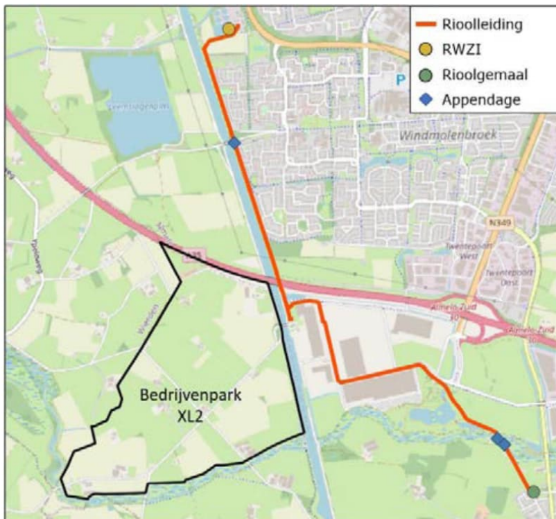
Figuur 15-4 Rioolpersleiding in de omgeving van het plangebied (bron: Royal HaskoningDHV, juli 2024)
