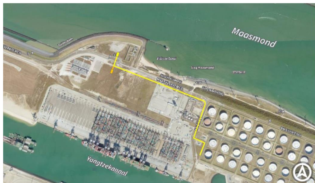
Figuur 2.7 Tracé van de zeeleiding op land (gele lijn) vanaf het mengpunt bij het Porthos compressorstation naar het startpunt van de kruising onder de zeekering en Maasgeul. (bron: MER Aramis)
