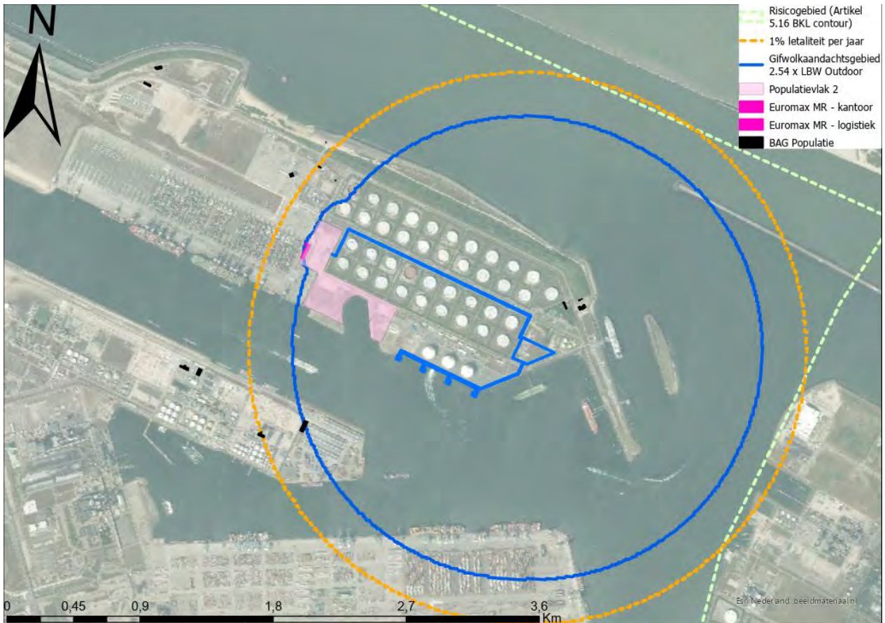
Figuur 8-4 Berekende aandachtsgebieden voor de terminal variant 'MOT – Bullets'
