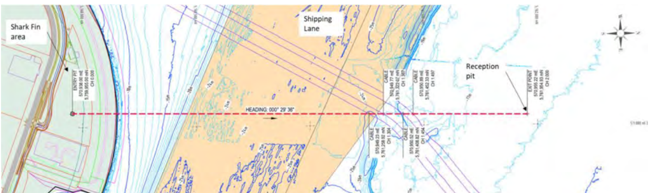
Figuur 4-4. Overzicht van de kruising van de Maasgeul. Bron: "Microtunnel Trajectory - North Option Plan View & Profile" Uit scope of work document 416010-00257 - ARM-CPT-BB3-PLR-REP-0047_1.0
