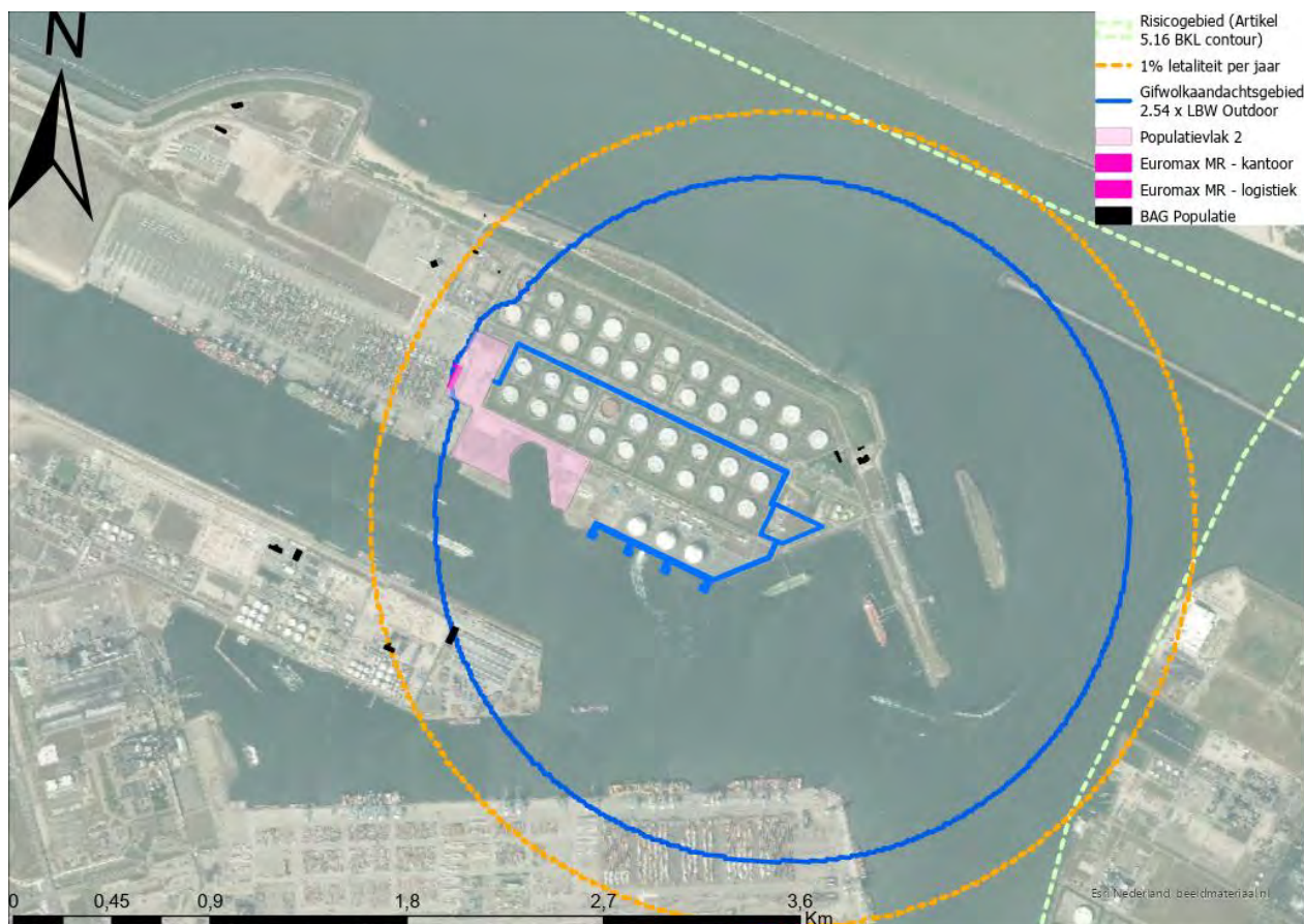
Figuur 8-7 Berekende aandachtsgebied en 1% letaliteitscontour voor het MOT terminal met bullet.
