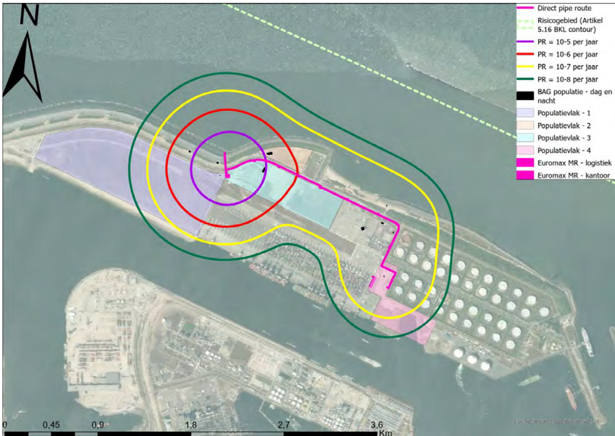
Figuur 8-17 PR-contouren voor de direct pipe route – aanvullende mitigerende maatregelen.
