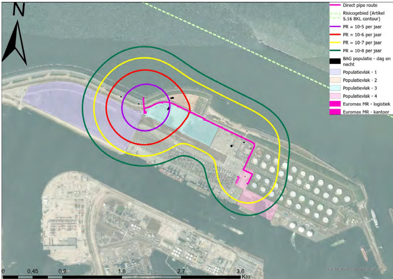
Figuur 7-1: PR voor de direct pipe route
