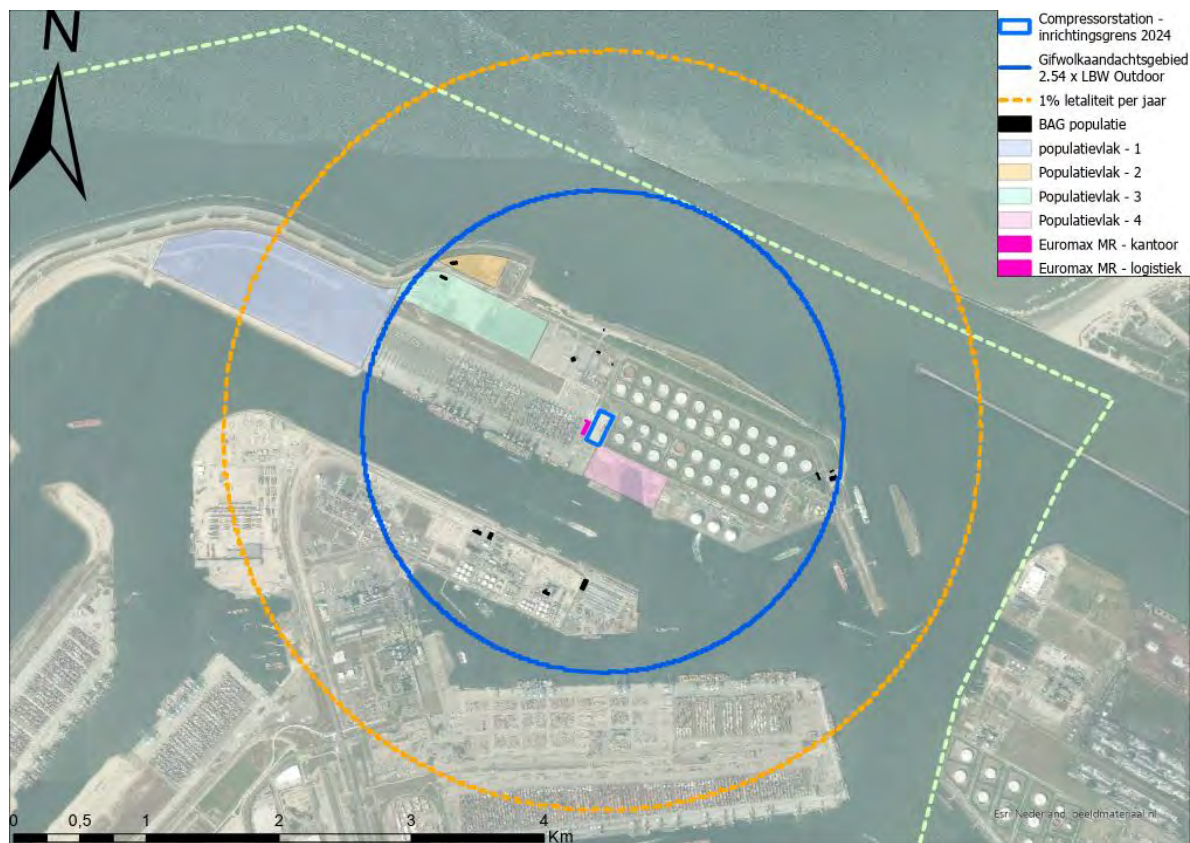
Figuur 8-12 Berekende aandachtsgebied en 1% letaliteitscontour voor het compressorstation – Productie naar Aramis zeeleiding
