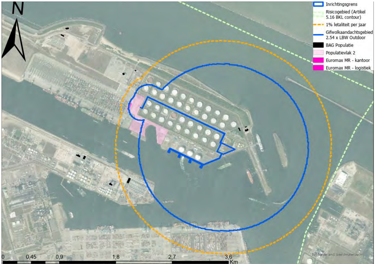
Figuur 8-6 Berekende aandachtsgebied en 1% letaliteitscontour voor het MOT terminal met spheres.
