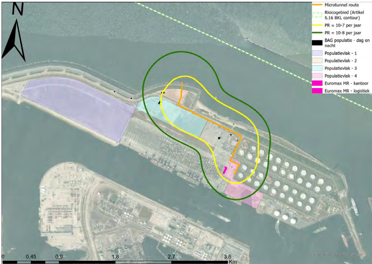
Figuur 8-1 PR-contouren voor de microtunnel route.
