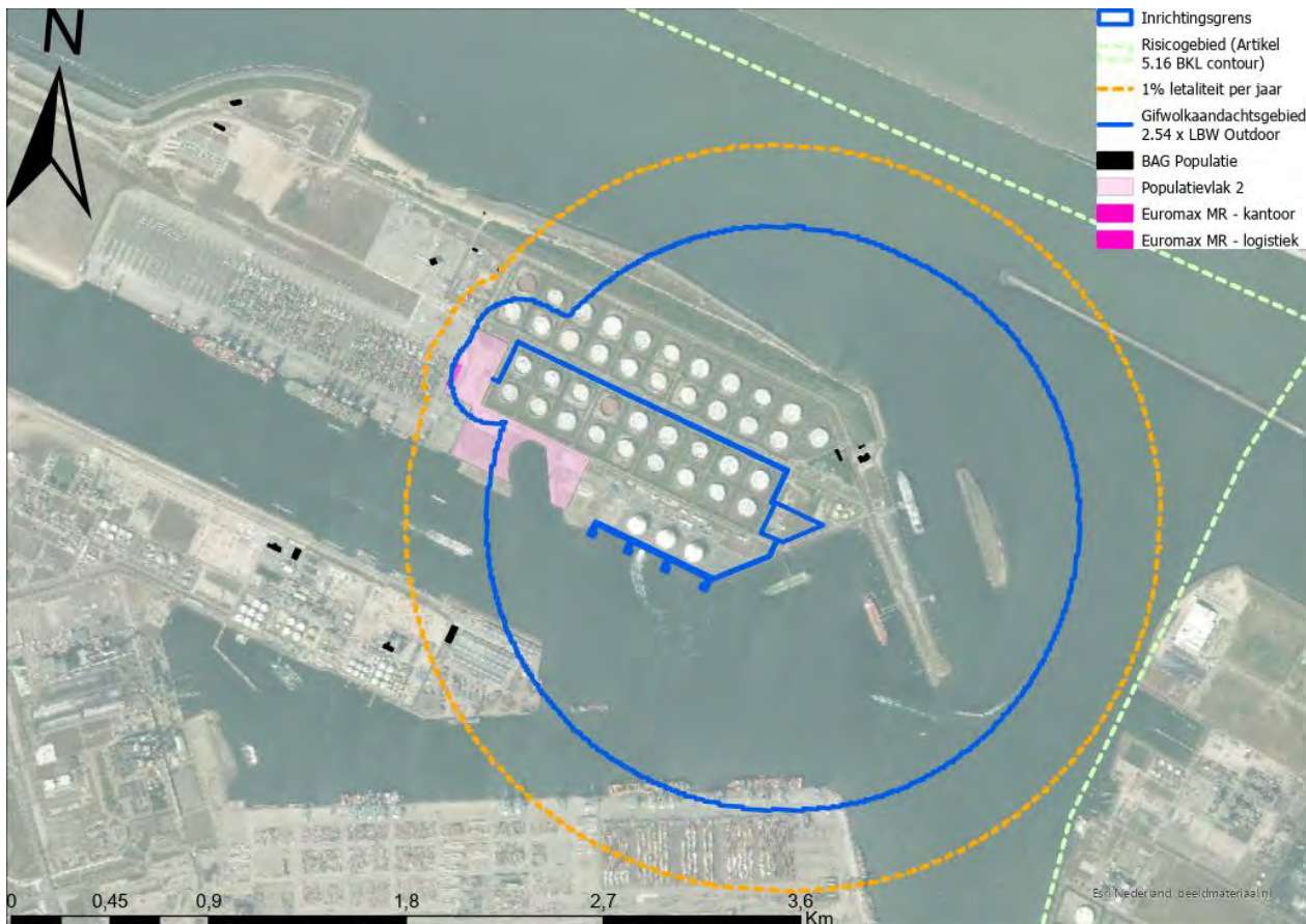
Figuur 8-2 Berekende aandachtsgebieden voor de voorgenoemde terminal variant 'MOT – Spheres'
