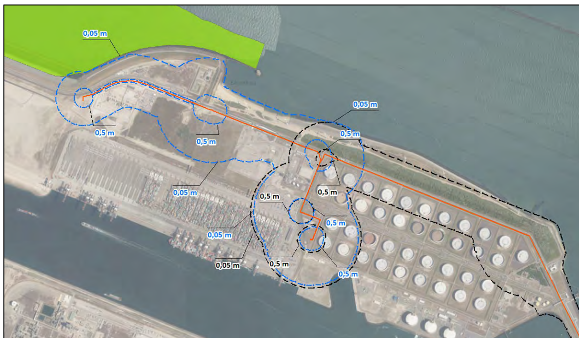
Figuur 4.4: Ligging Natura2000-gebied t.o.v. invloedsgebied GHG-situatie nabij aansluiting tracé op 2 e Maasvlakte.
