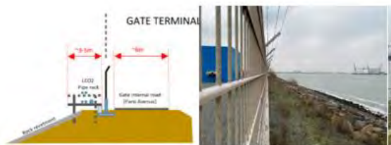
Figuur 6.3 Visualisatie ligging pipe rack op talud (links) en foto talud met hekwerk (rechts, gespiegeld t.o.v. visualisatie)
