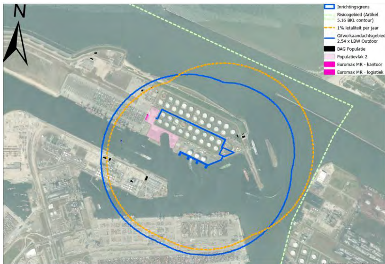
Figuur 8.3 Berekende gifwolk aandachtsgebied voor de voorgenomen terminal met CO 2 -opslag in 'spheres'
