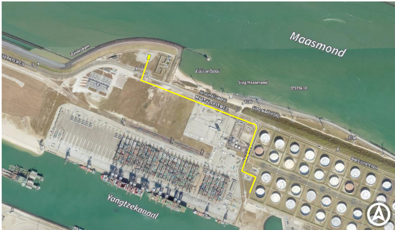
Figuur 3-1. Tracé van de zeeleiding op land met de geplande locatie voor de kruising van de zeewering ten noorden van de Maasvlakteweg (bron foto Street Smart – Cyclomedia).
