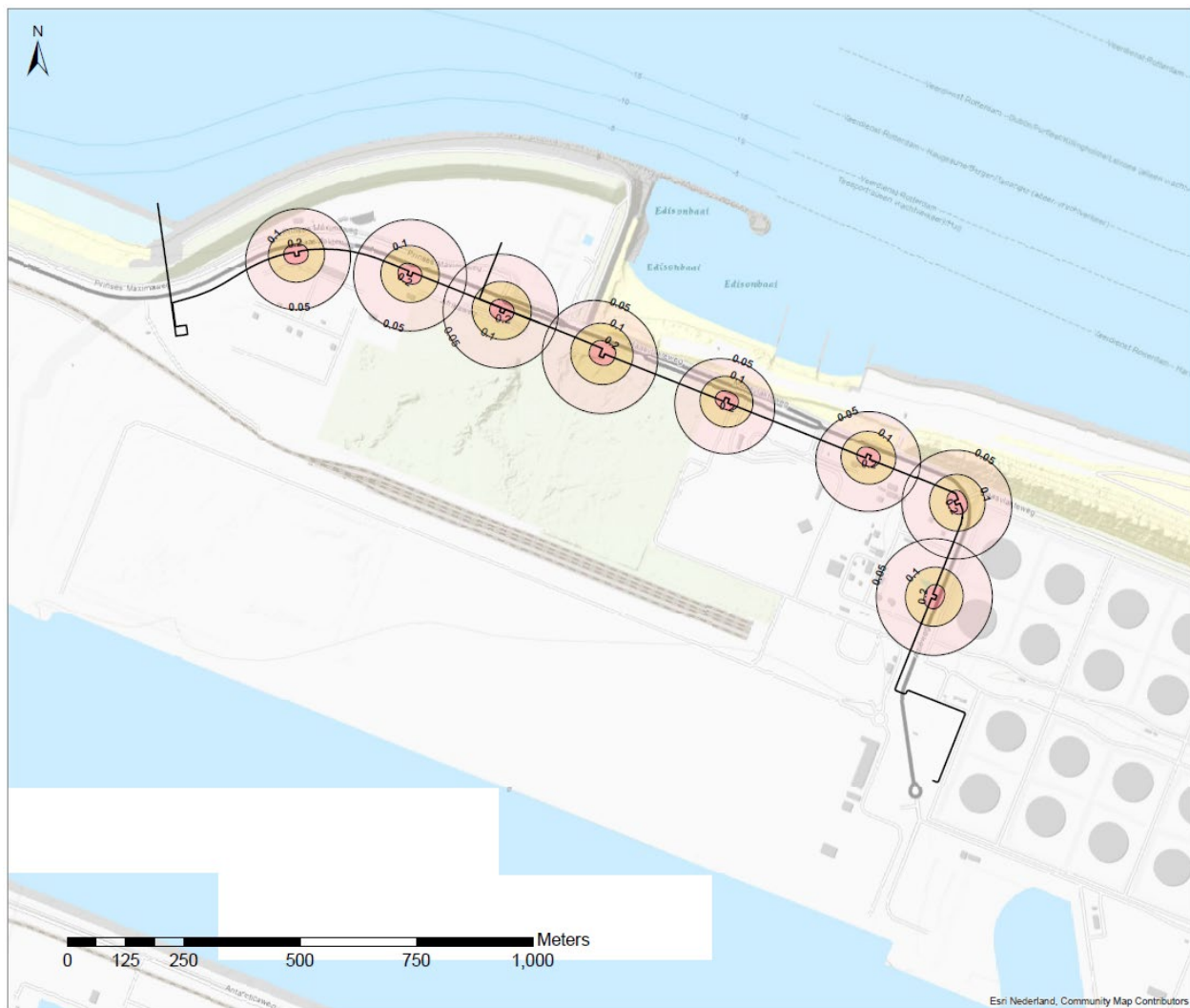
Figuur 5-5 Berekende verlaging bij gemiddeld laagste grondwaterstand
