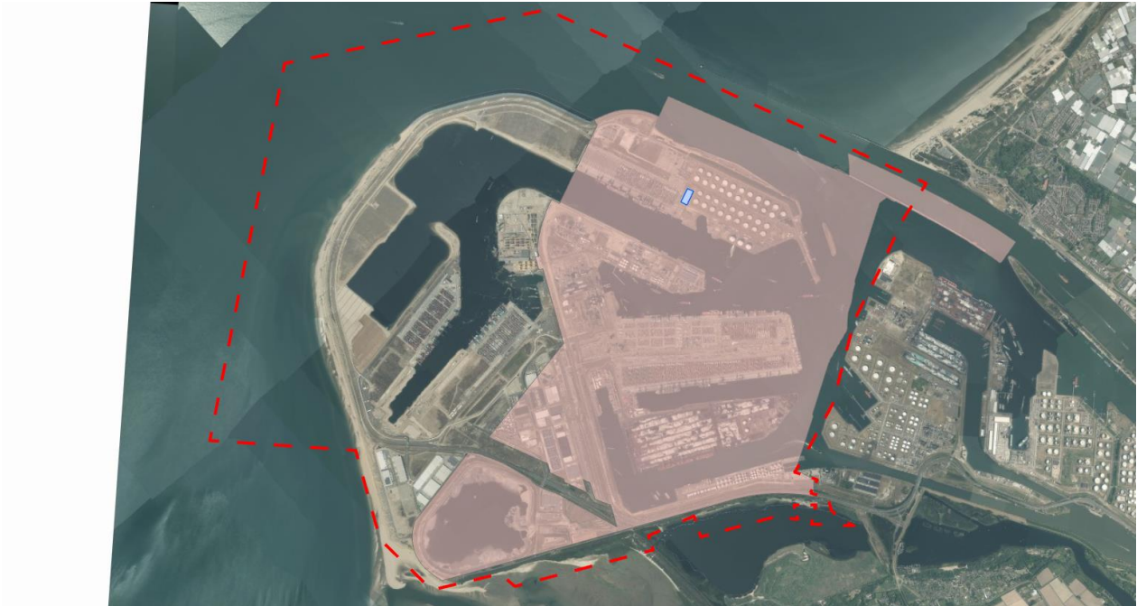
Figuur 3-2: Het roze vlak representeert het plangebied 'Maasvlakte 1', de rode contour representeert het risicogebied en het blauwe vlak markeert de voorgenomen locatie van het compressorstation.
