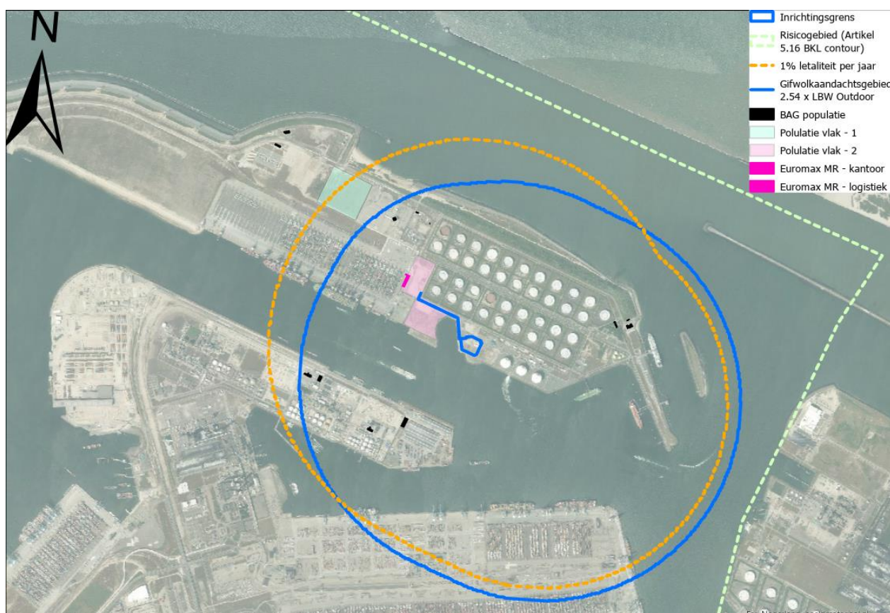
Figuur 9-2 Berekende aandachtsgebieden voor de terminal variant 'Gate-terrein – spheres'
