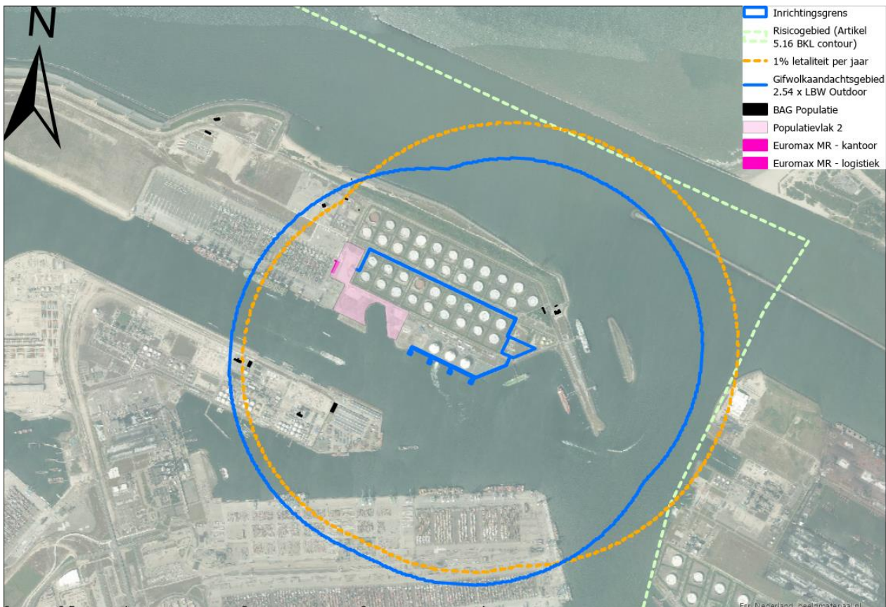
Figuur 8-4 Berekende aandachtsgebieden voor de terminal variant ‘MOT – Bullets’
