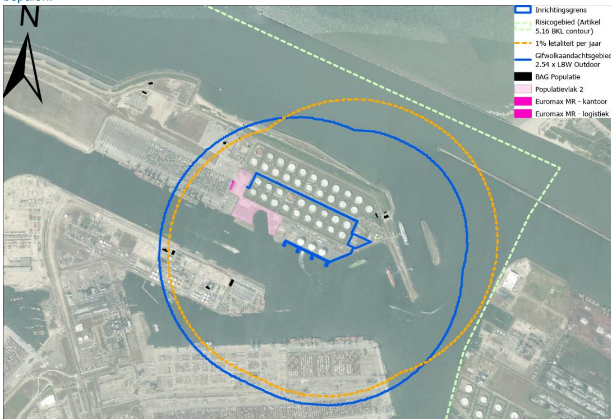
Figuur 8-2 Berekende aandachtsgebieden voor de voorgenomen terminal variant 'MOT – Spheres'
