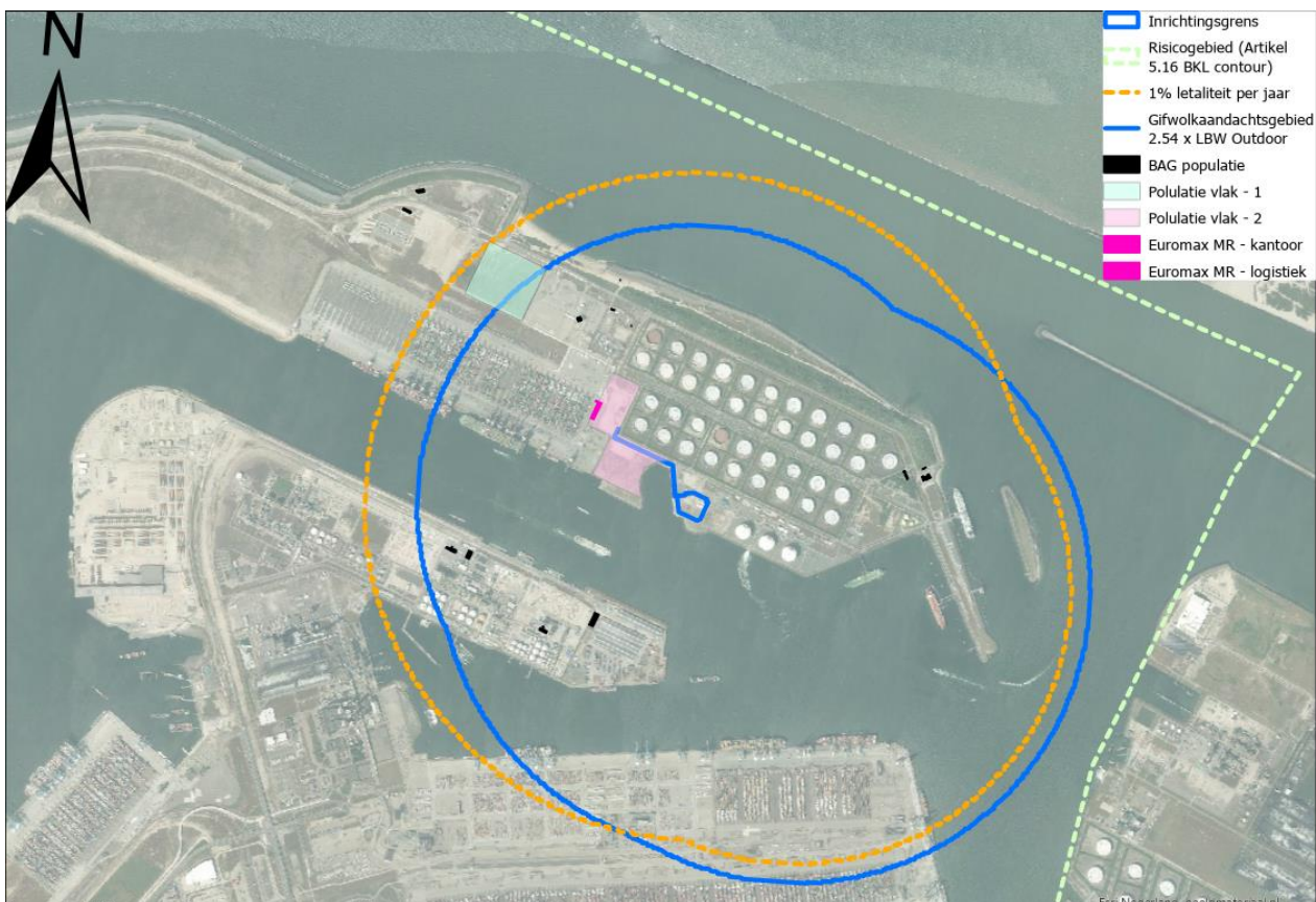
Figuur 9-5 Berekende aandachtsgebieden voor de terminal variant ‘Gate-terrein – bullets’
