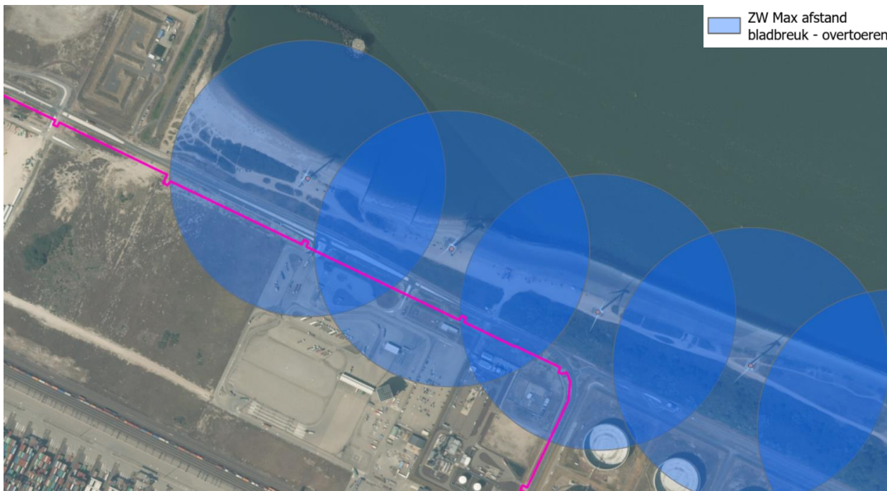
Figuur 10-1: Windturbines Zuidwal - Zeeleiding segmenten waar schade kan ontstaan door interactie met windturbine onderdelen
