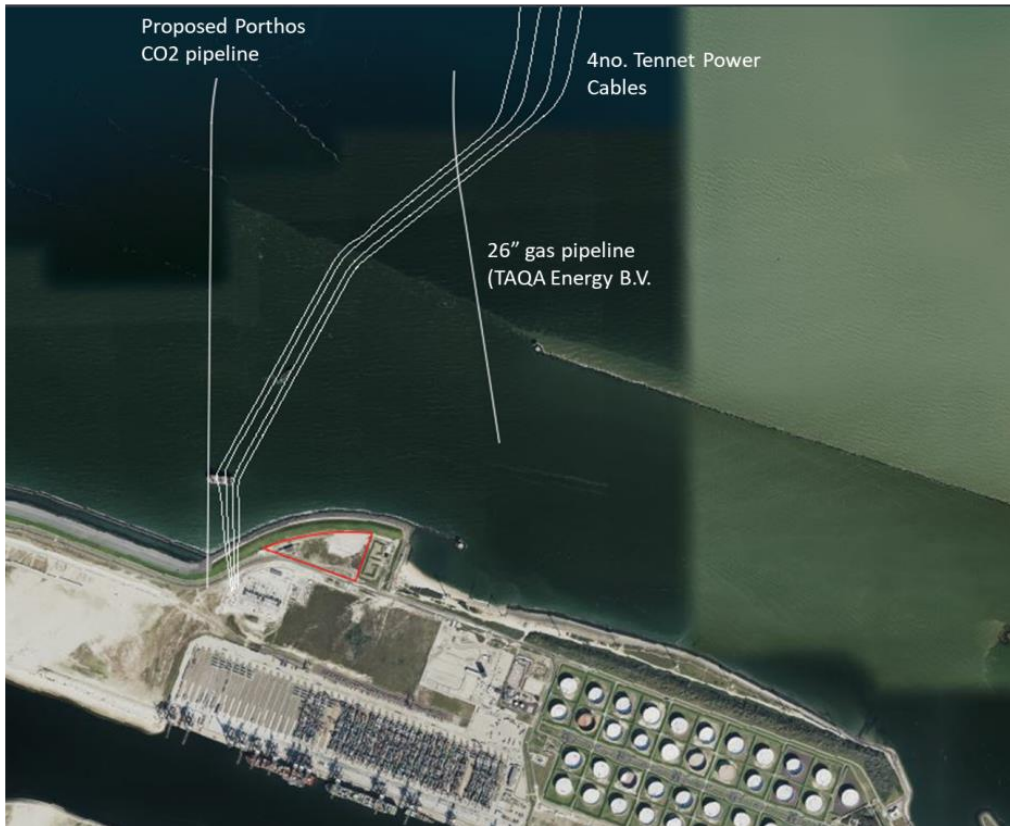
Figuur 4-1: Overzicht van de geplande pijpleidingen nabij landingspunt Source: Imagery from © 2022 Microsoft Corporation © 2022 Maxar © CNES (2022) Distribution Airbus DS, assets from drawing ARM-CPT-BB3-PLR-LAY-0045
