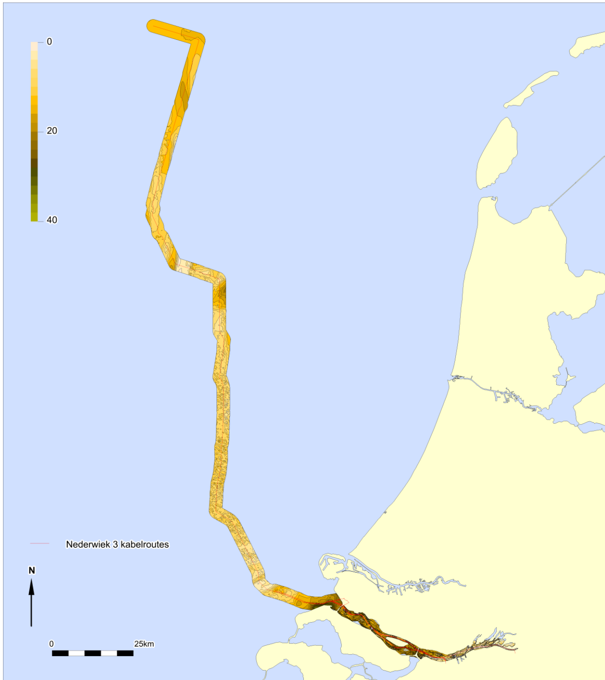
Afbeelding 24. Dikte Holocene Laag (bron grid data: TNO, GeoTOP en DHY)
