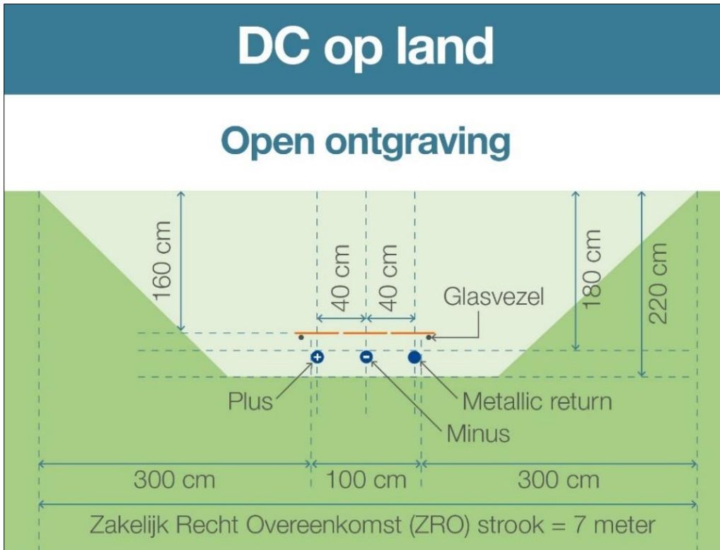
Figuur 2-7 Kabelconfiguratie open ontgraving op land Nederwiek 3
