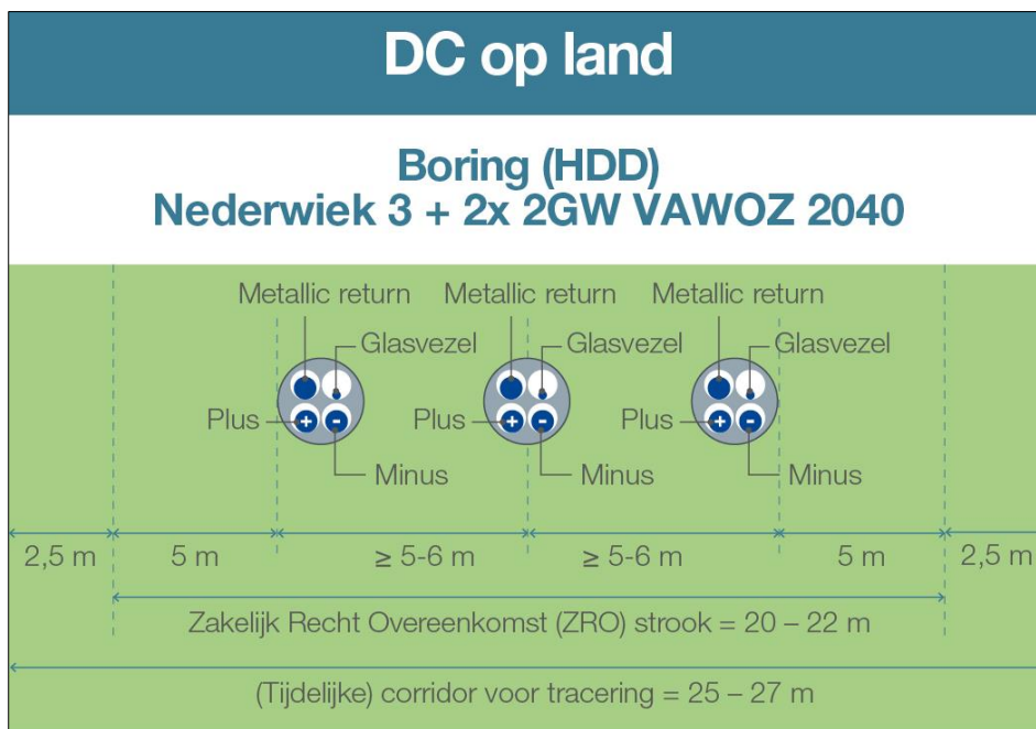
Figuur 2-12 Kabelconfiguratie boring op land drie kabelsystemen
