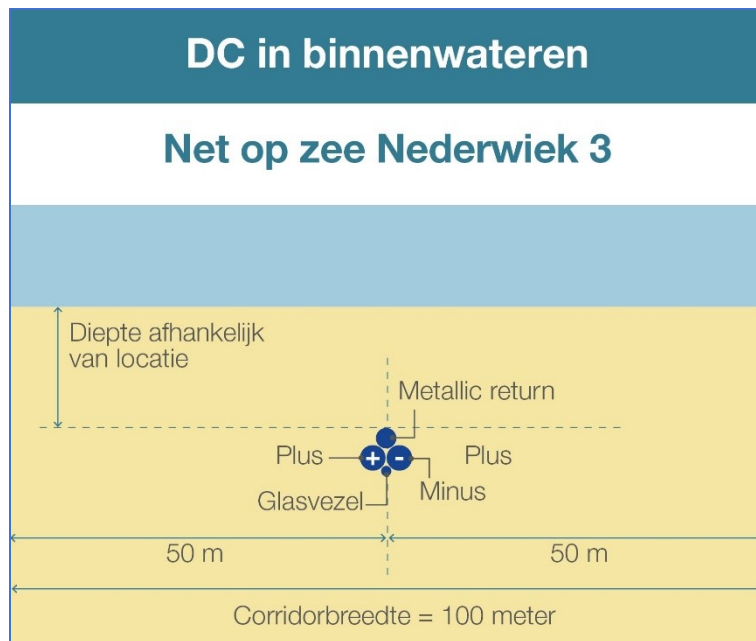
Afbeelding 11. Kabelconfiguratie Nederwiek 3 Binnenwateren Amer
