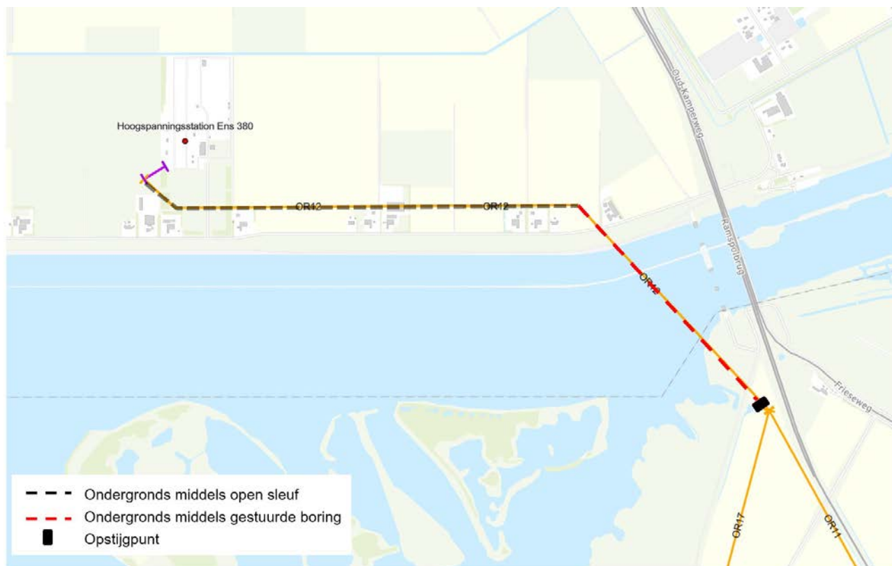
Figuur 1.9 Situatie ondergrondse aanleg bij deeltracé OR12
