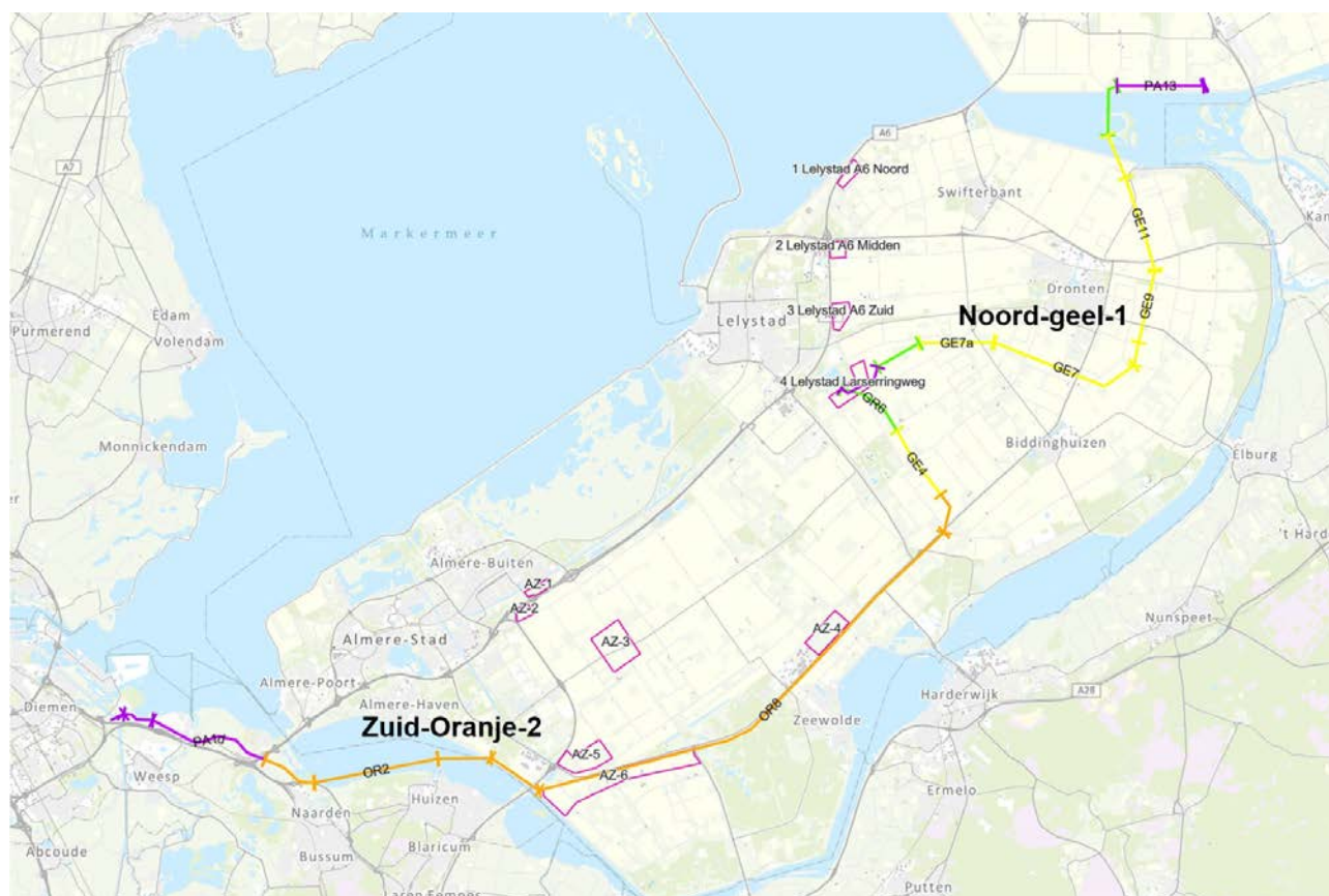
Figuur 1.3 Uitsnede met daarop de referentielijn van Zuid-Oranje-2, tussen het bestaande hoogspanningsstation Diemen en het meest zuidelijke locatiealternatief voor hoogspanningsstation Lelystad. En de referentielijn Noord-Geel-1 tussen het meest zuidelijke hoogspanningsstation Lelystad en het bestaande hoogspanningsstation Ens
