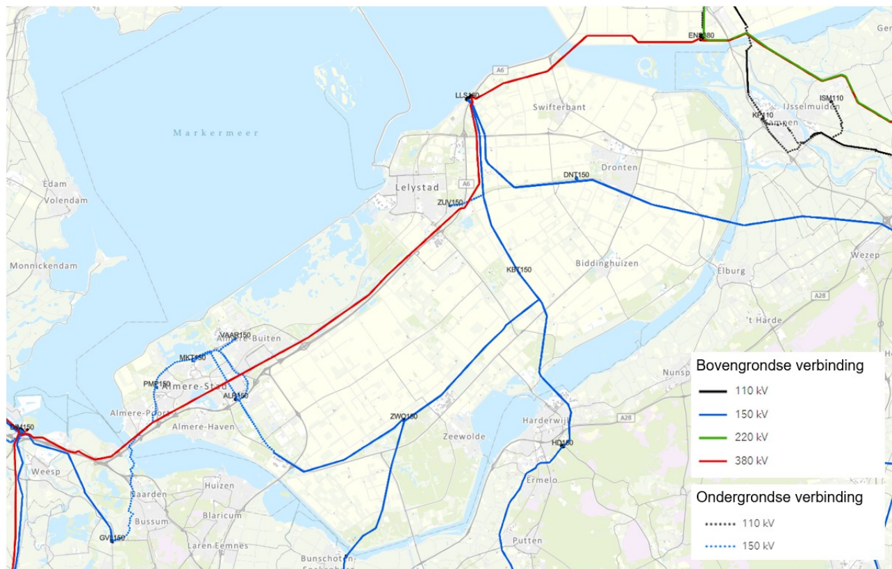
Figuur 4.3 Bestaande bovengrondse en ondergrondse hoogspanningsverbindingen in het onderzoeksgebied
