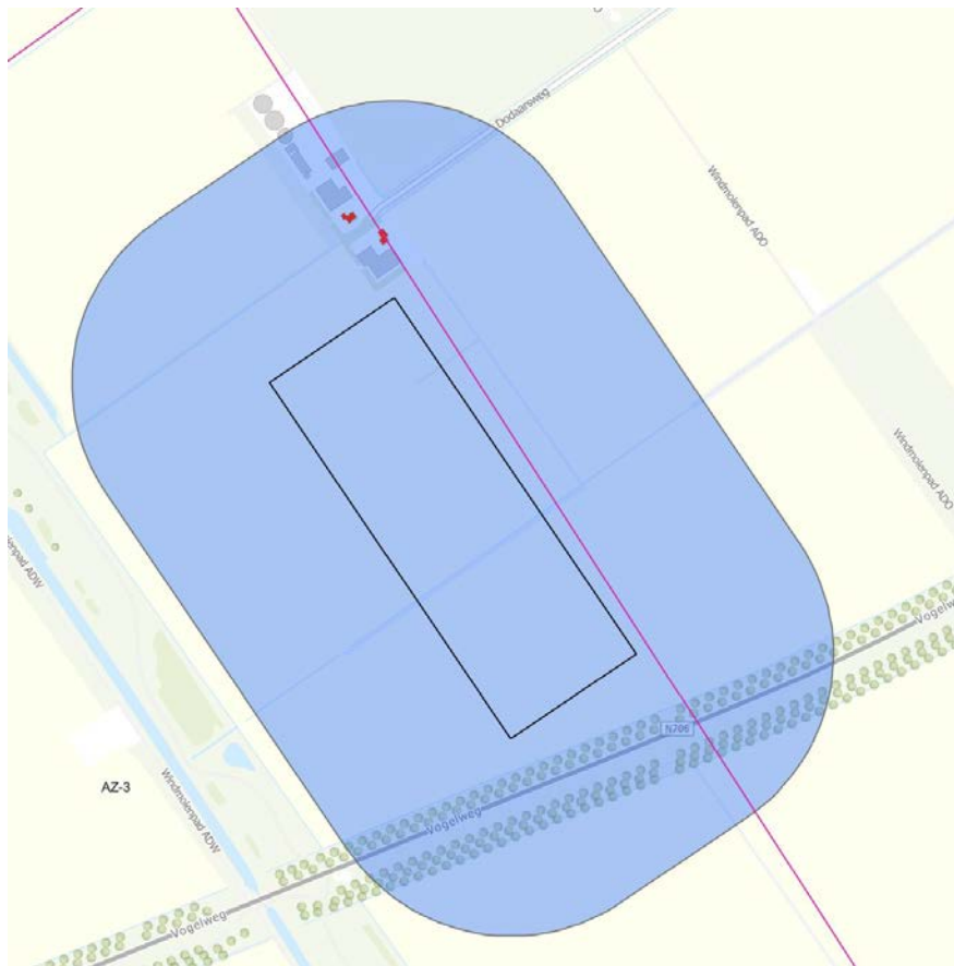
Figuur 7.6 Overlap van de belemmeringszone voor geluid (realisatiefase), van AZ-3 met geluidgevoelige bestemmingen
