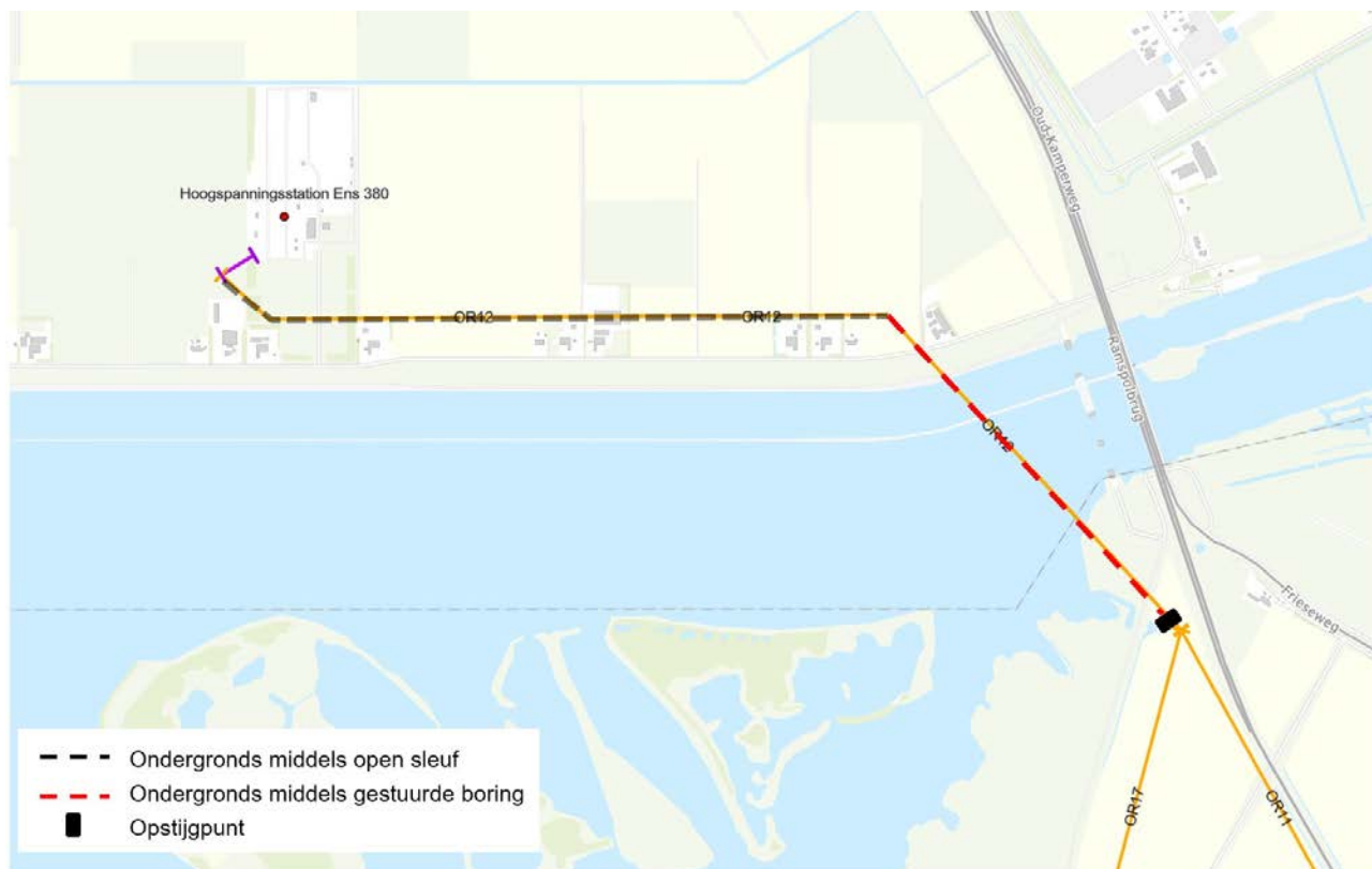
Figuur 1.9 Situatie ondergrondse aanleg bij deeltracé OR12
