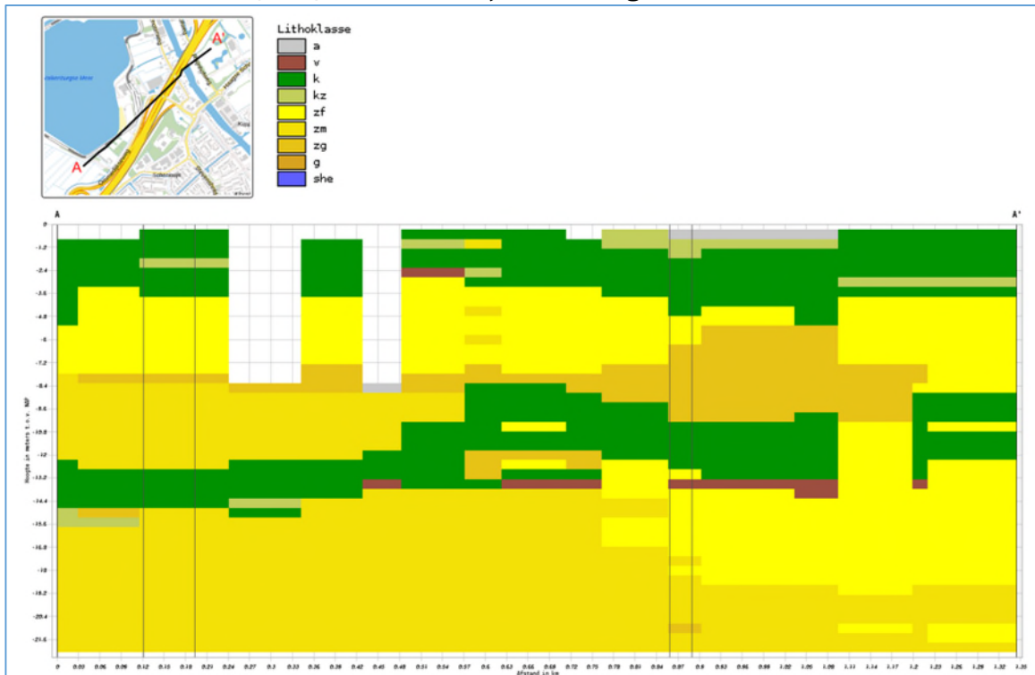
Figuur B4-19 Bodemopbouw nabij de innamepunten en voorzuiveringen van varianten 1.3a, 1.3c
