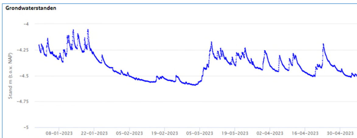
Figuur B3-7 Grondwaterstanden bij put GLD000000039061 bij inname locatie en voorzuiveringslocatie de Vliet Rijnland (locatievariant 1.2)
