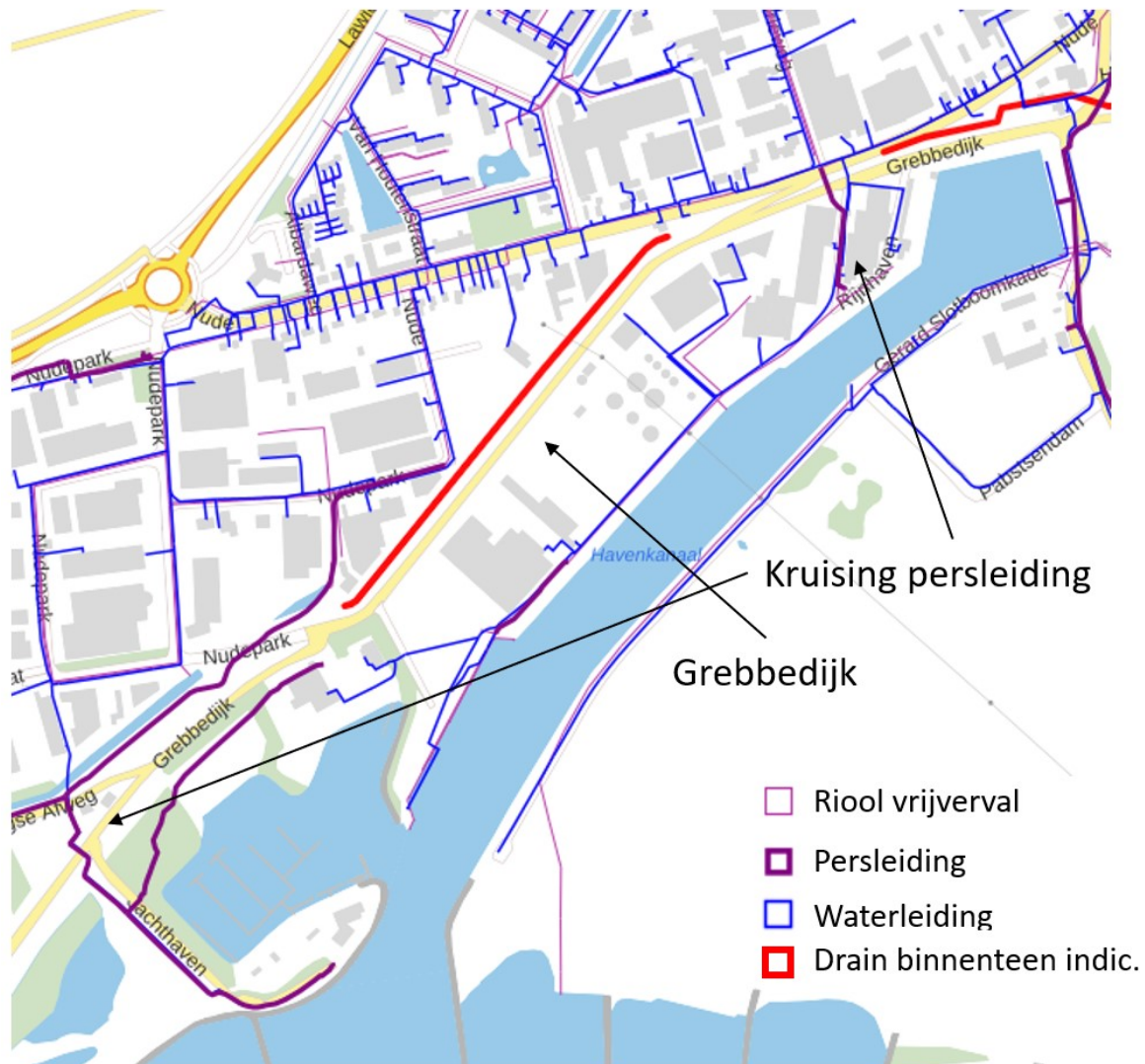
Afbeelding 3.27 Detail van de riolering, persleiding en waterleiding in deelgebied 2
