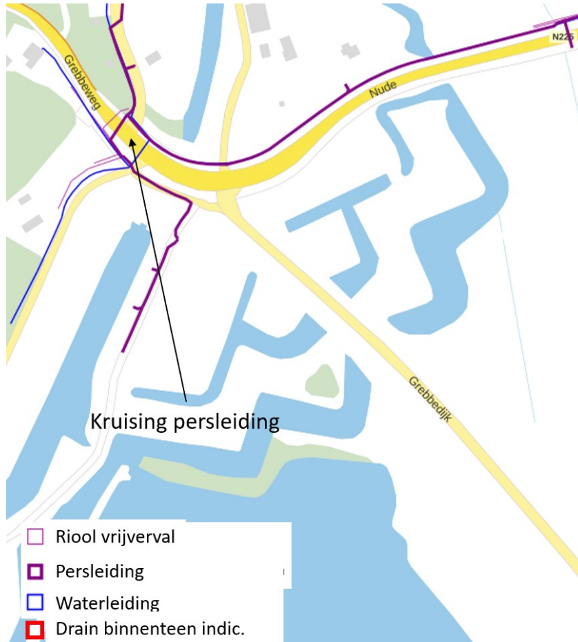
Afbeelding 3.29 Detail van de riolering, persleiding en waterleiding in deelgebied 4
