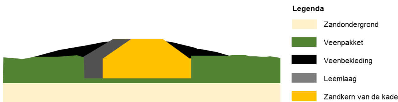
Figuur 7: schematische opbouw van de kades
