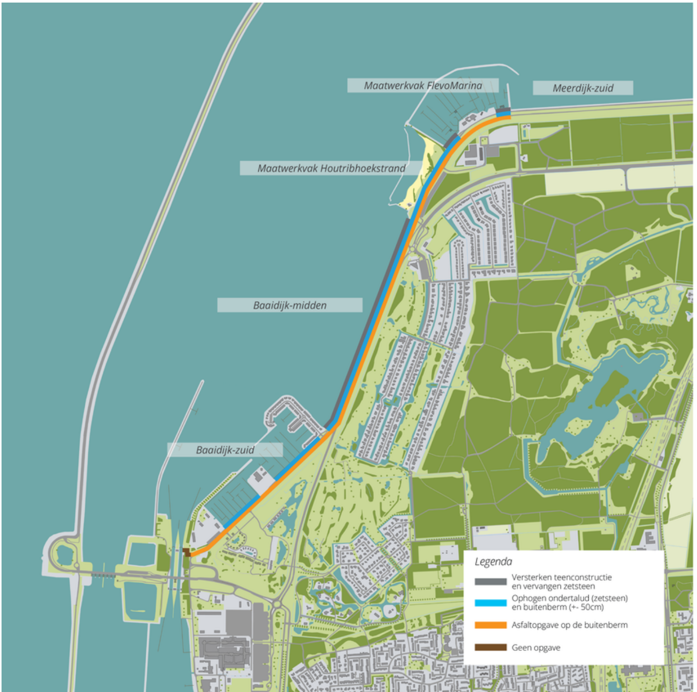
Overzicht van de deeltrajecten in het dijkvak 'Baaidijk'
