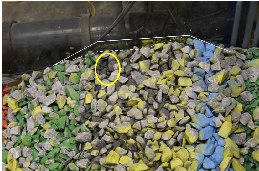
Figuur 5-23: Foto van schade aan kruin langsdam na T310 (achterzijde)
