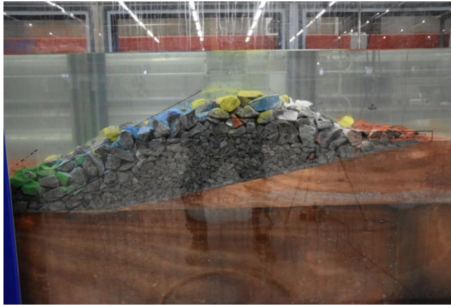
Figuur 5-21: Foto van schade aan voorzijde kruin langsdam na T210
