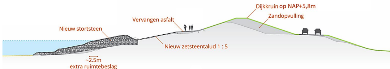
Figuur 4-33: Dwarsdoorsnede van het referentieontwerp op het traject Meerdijk-midden
