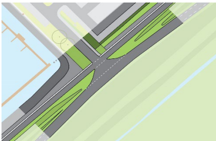
Figuur 4-29: Plattegrond van de nieuwe aansluiting van DEKO Marina met een doorgetrokken binnenberm
