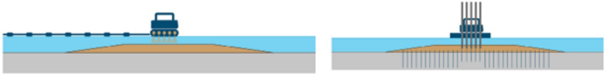
Stap 1: Aanbrengen basis zandlaag.
