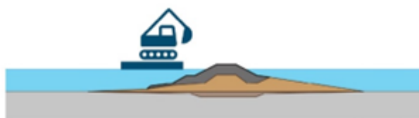
Stap 1c: In aantal ophoogslagen voorbelasting aanbrengen.
