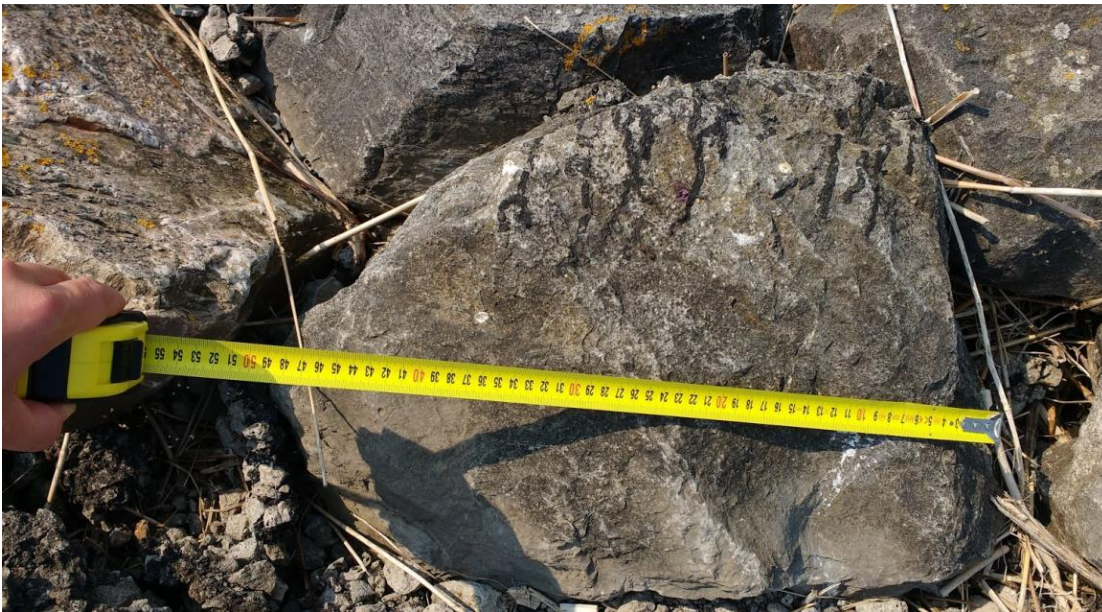
Figuur 0-3 Voorbeeld opname steendiameter dammen Flevo Marina (Bron: Logboek-HAV 0.1)
